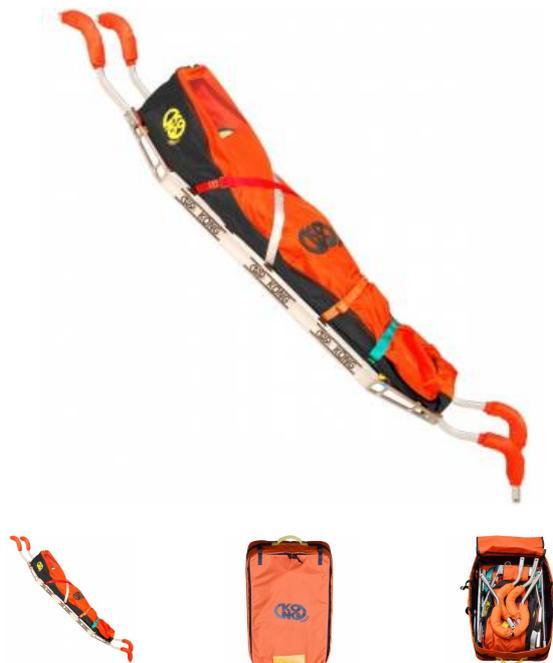
condiciones reales para utilizar la camilla y ha sido sometido a varias pruebas destructivas con tracción lenta. El kit para colgar la camilla desde un helicóptero o desde uso en teleférico puede soportar una carga SWL de 500kg (factor de seguridad 1:4). La cinta ancha para bajar la camilla, si ha sido insertado correctamente y según las instrucciones, se garantiza para una carga de 400kg (factor de seguridad 1:4).
