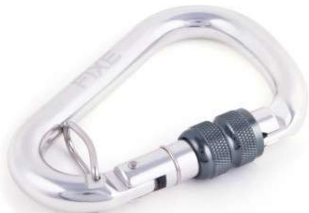
Mosquetón HMS de seguridad rosca de gran apertura y tamaño con antigiro. Fabricado en aluminio con perfil circular para ser usado con nudos dinámicos. Pequeño gatillo para ajustarlo al anillo ventral del arnés. El mosquetón trabaja siempre con la misma carga. Recomendado para asegurar en escalada deportiva y rocódromo.
